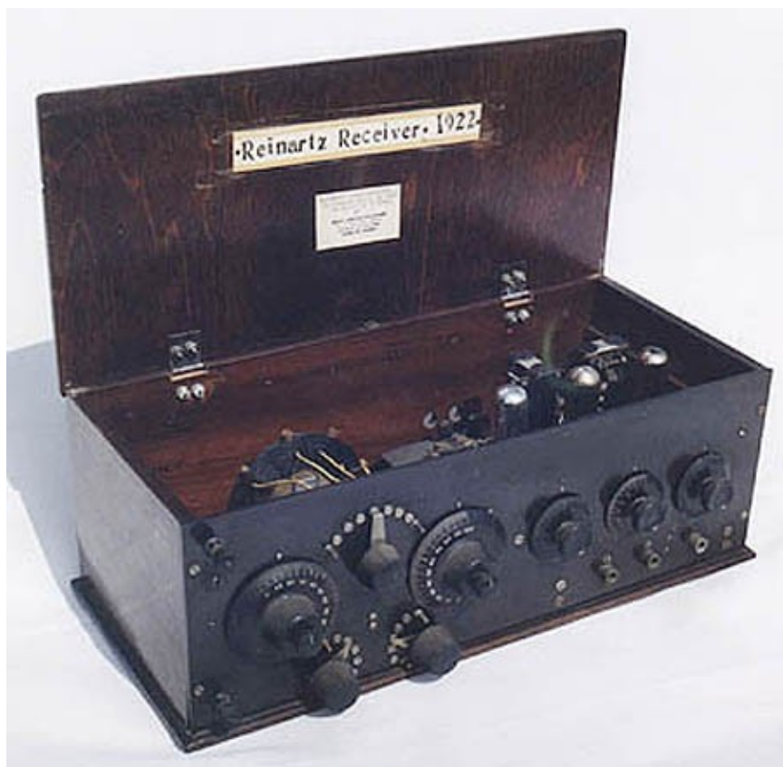
Figura: Montagem típica de um receptor de 1922, com o famoso circuito de detector de Reinartz*, que foi utilizado para este contato histórico.
