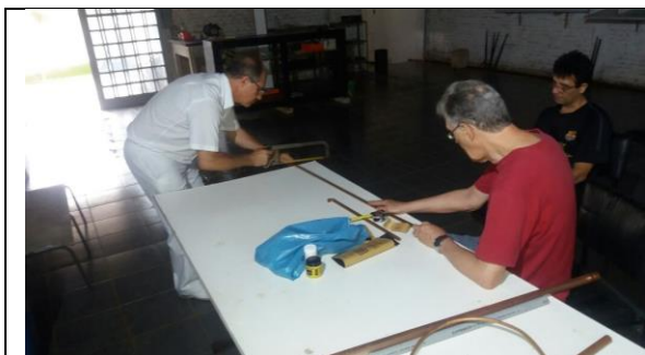
Cotando o tubo e pré montando a antena.
