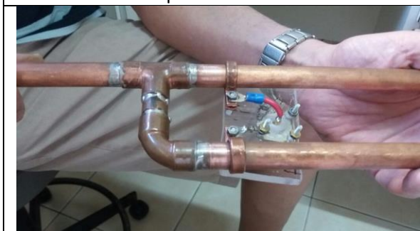
Montagem do isolador e conector coaxial.
