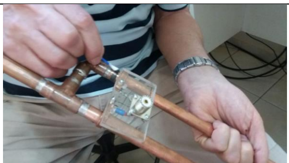
Montagem do isolador e conector coaxial.
